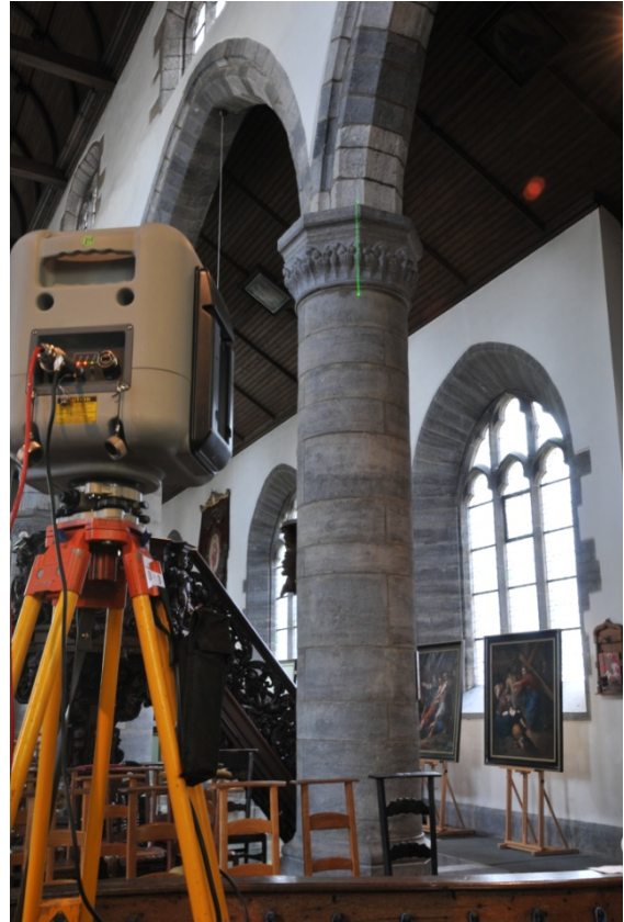
Foto: Trimble GX scanner in actie in de kerk
